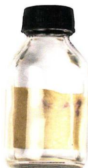
Álcool isopropílico Álcool bastante puro utilizado para limpeza de componentes por conta de seu poder de evaporação e da baixa quantidade de água.
